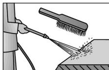
Der Untergrund muss vorbereitet werden (frei von Fett, Staub und Zementleim; keine losen Bestandteile an der Oberfläche).
